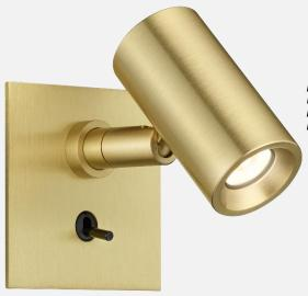
Fixation par vis cachée par l'avant Une double plaque pivote sur l'axe de la liseuse pour recouvrir la fixation de bas et cacher les vis. Le driver est installé à l'arrière.
